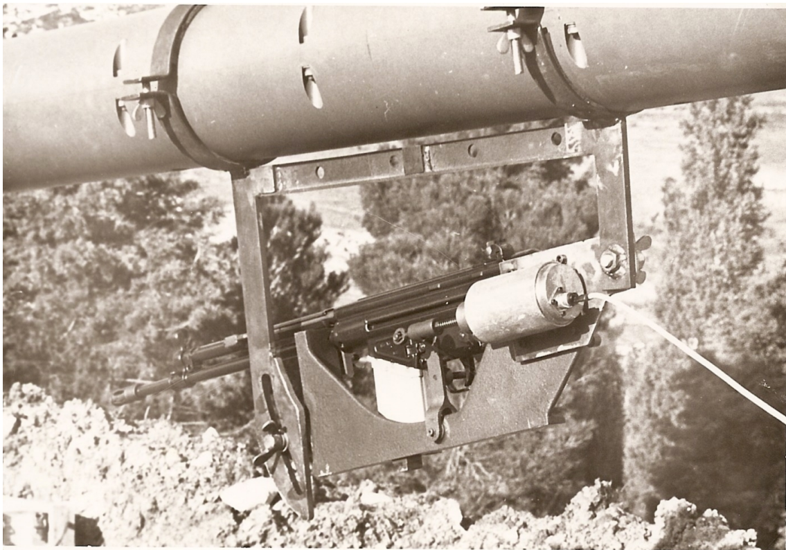
Prototype, vue \frac{3}{4} gauche de la platine avec support équipé de l'arme G 3 A3, solénoïde monté.
